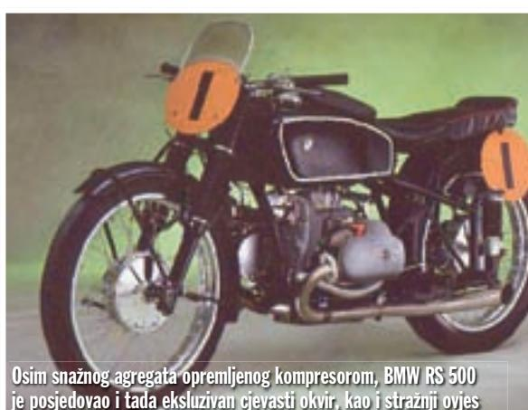
Osim snažnog agregata opremljenog kompresorom, BMW RS 500 je posjedovao i tada ekskluzivan cjevasti okvir, kao i stražnji ovjes
