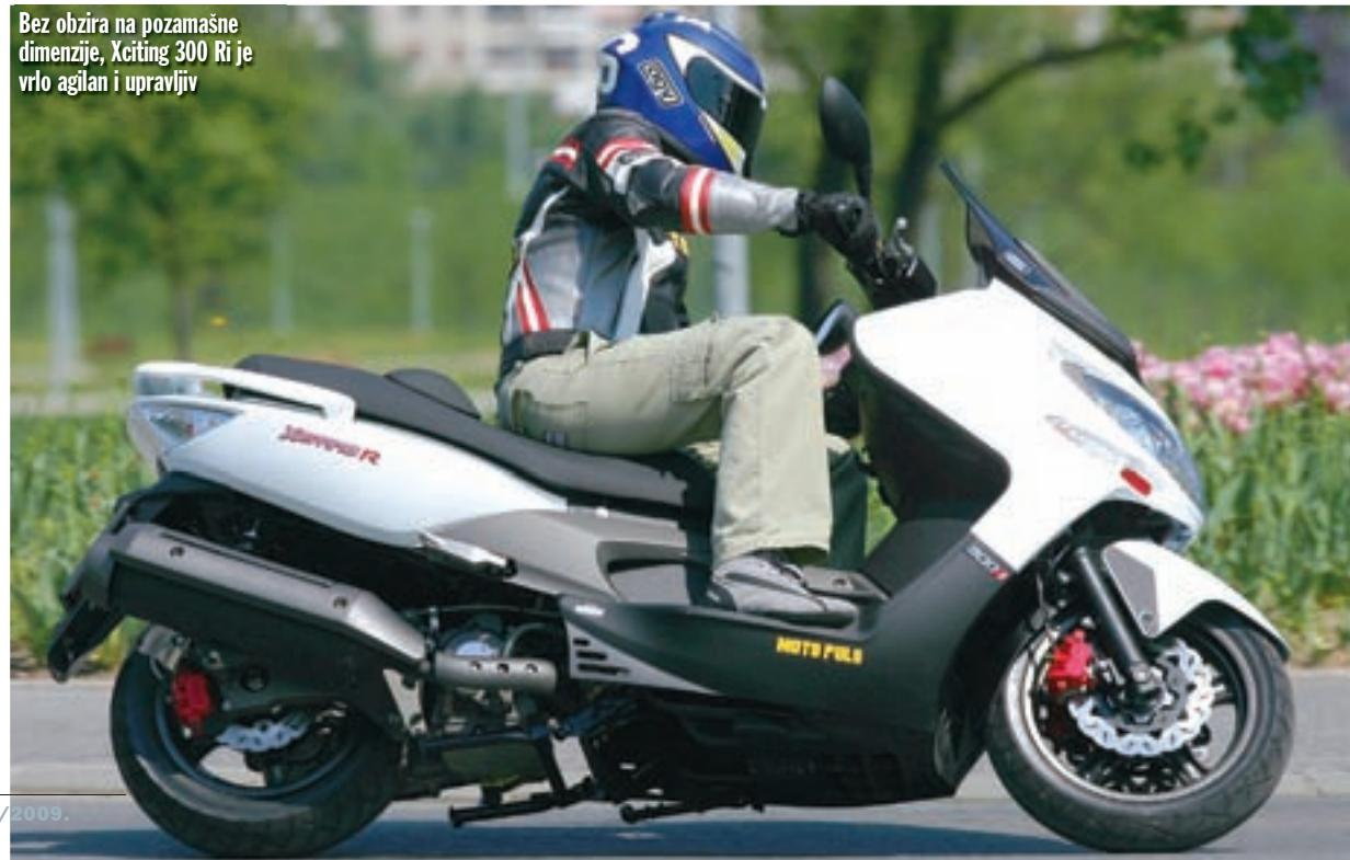
**XCITING R****TEHNIČKI PODACI****Motor:** jednocijlindrični, četverotaktni**Obujam:** 270,6 ccm**Hlađenje:** tekućinom**Paljenje:** elektronsko**Napajanje:** elektronsko**Spojka:** automatska centrifugalna**Mjenjač:** CVT**Okvir:** čelični cijevasti**Ovjes:** teleskopska vilica; straga agregat kao ovješeni element s dva amortizera**Gume:** prednja 120/70-15,
