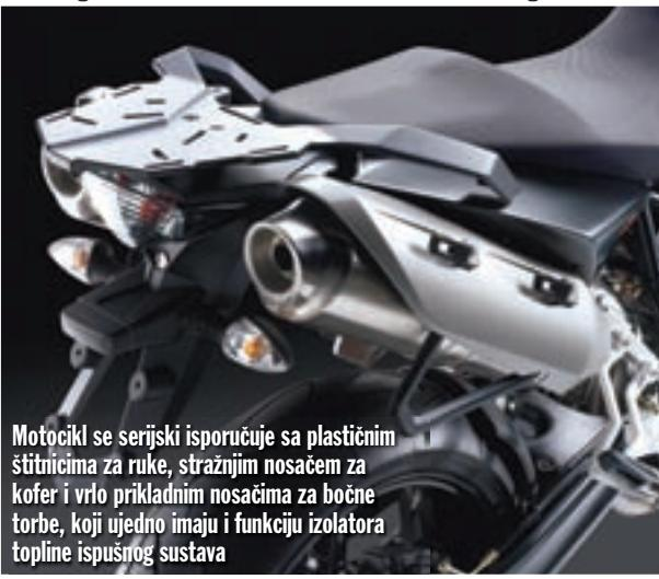
Motocikl se serijski isporučuje sa plastičnim štitnicima za ruke, stražnjim nosačem za kofer i vrlo prikladnim nosačima za bočne torbe, koji ujedno imaju i funkciju izolatora topline ispušnog sustava
