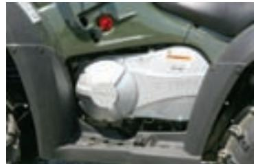
▲ Plastične oplate skrivaju da ovaj četverocikl pokreće tekućinom hlađeni V2 agregat zapremine 514 ccm
