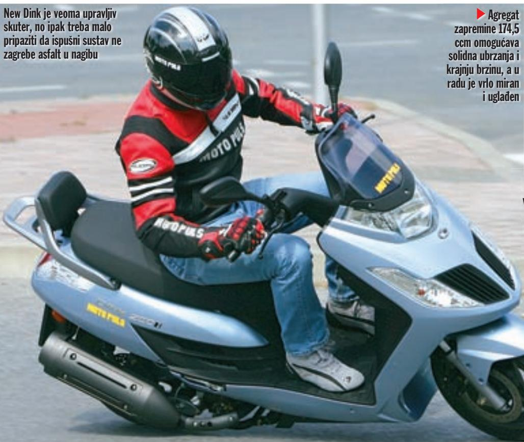
► Agregat zapremine 174,5 ccm omogućava solidna ubrzanja i krajnju brzinu, a u radu je vrlo miran i uglađen
