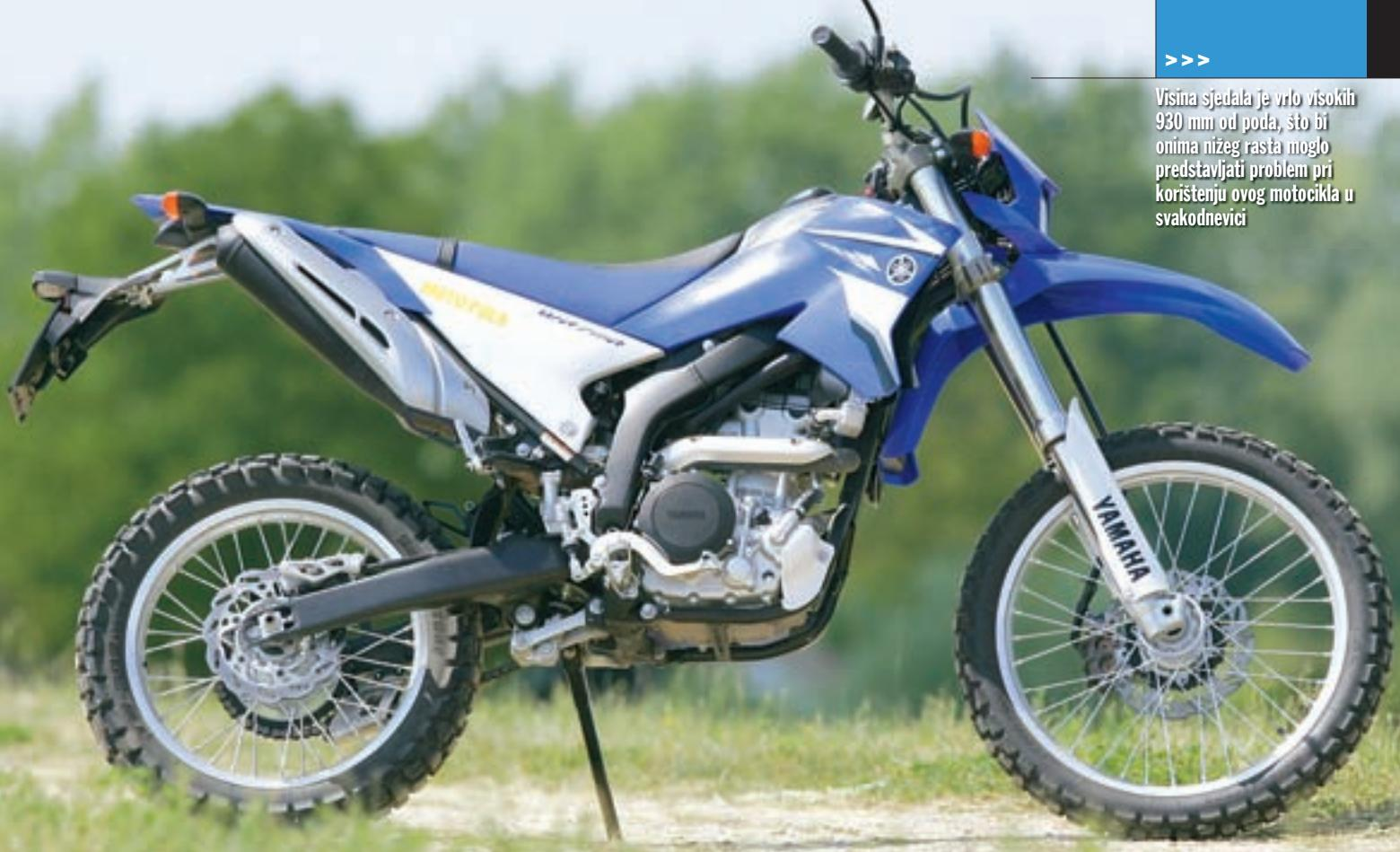
mogu pohvaliti s pet ventila - agregat na WR-u 250R koristi klasično rješenje od četiri ventila, s tim da su usisni ventili od titana i promjera su 30 mm, dok su ispušni ventili promjera 24,5 mm.
