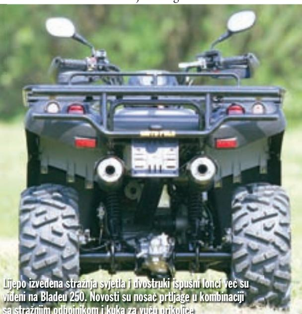
Ljepo izvedena stražnja svjetla i dvostruki ispušni lonci već su vidi na Bladeu 250. Novosti su nosač prtljage u kombinaciji sa stražnjim odbojnikom i kuka za vuču prikolice.
