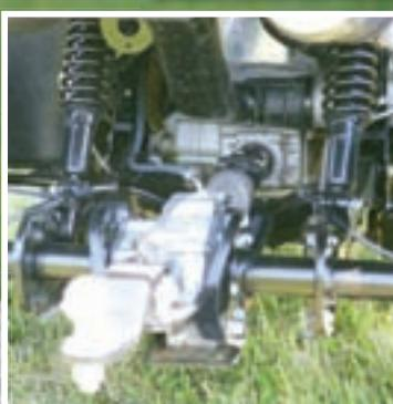
▶ lako posjeduje dvostruke stražnje amortizere, TGB Blade ima krutu stražnju osovinu, a ne rješenje neovisnog ovjesa, koje se češće koristi kod radnih četverocikala ove zapremine
