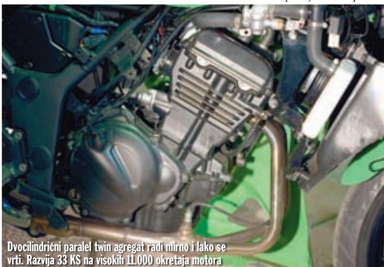
Dvocilindrični paralel twin agregat radi mirno i lako se vrti. Razvija 33 KS na visokih 11.000 okretaja motora
