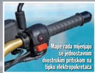
Mape rada mijenjaju se jednostavnim dvostrukim pritiskom na tipku elektropokretaca
