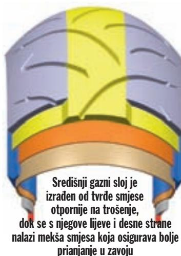
Središnji gazni sloj je izrađen od tvrde smjese otpornije na trošenje, dok se s njegove lijeve i desne strane nalazi mekska smjesa koja osigurava bolje prianjanje u zavoju
