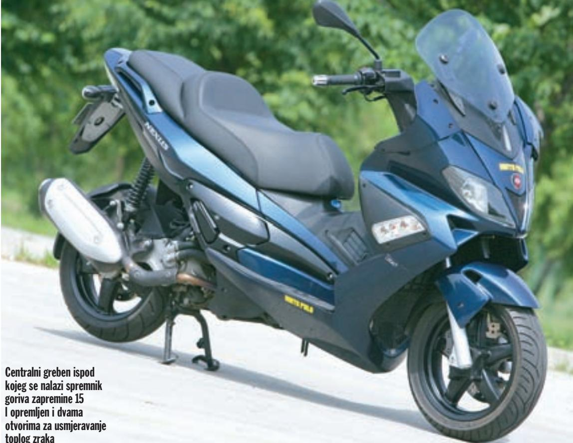
**Centralni greben ispod kojeg se nalazi spremnik goriva zapremljen 15 l opremljen i dvama otvorima za usmjeravanje toplog zraka**
