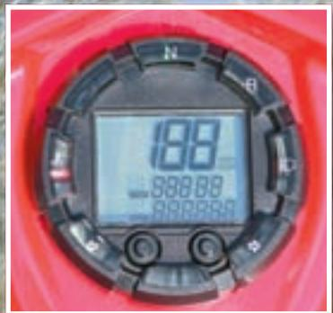
Digitalni instrumenti pružaju osnovne informacije, a tu su i sve potrebne kontrolne žaruljice. Izuzemno li tipku startera, prekidači ne odstupaju od onog što viđamo i na drugim tajvanskim četverociklima
