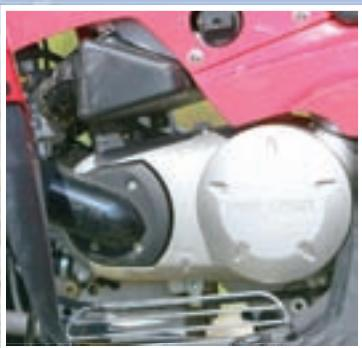
▲ Tekućinom hlađen pogonski agregat razvija 15,5 KS pri 7.750 okr/min, a to su konkurentne vrijednosti s obzirom na njegovu zapreminu od 176,3 ccm
