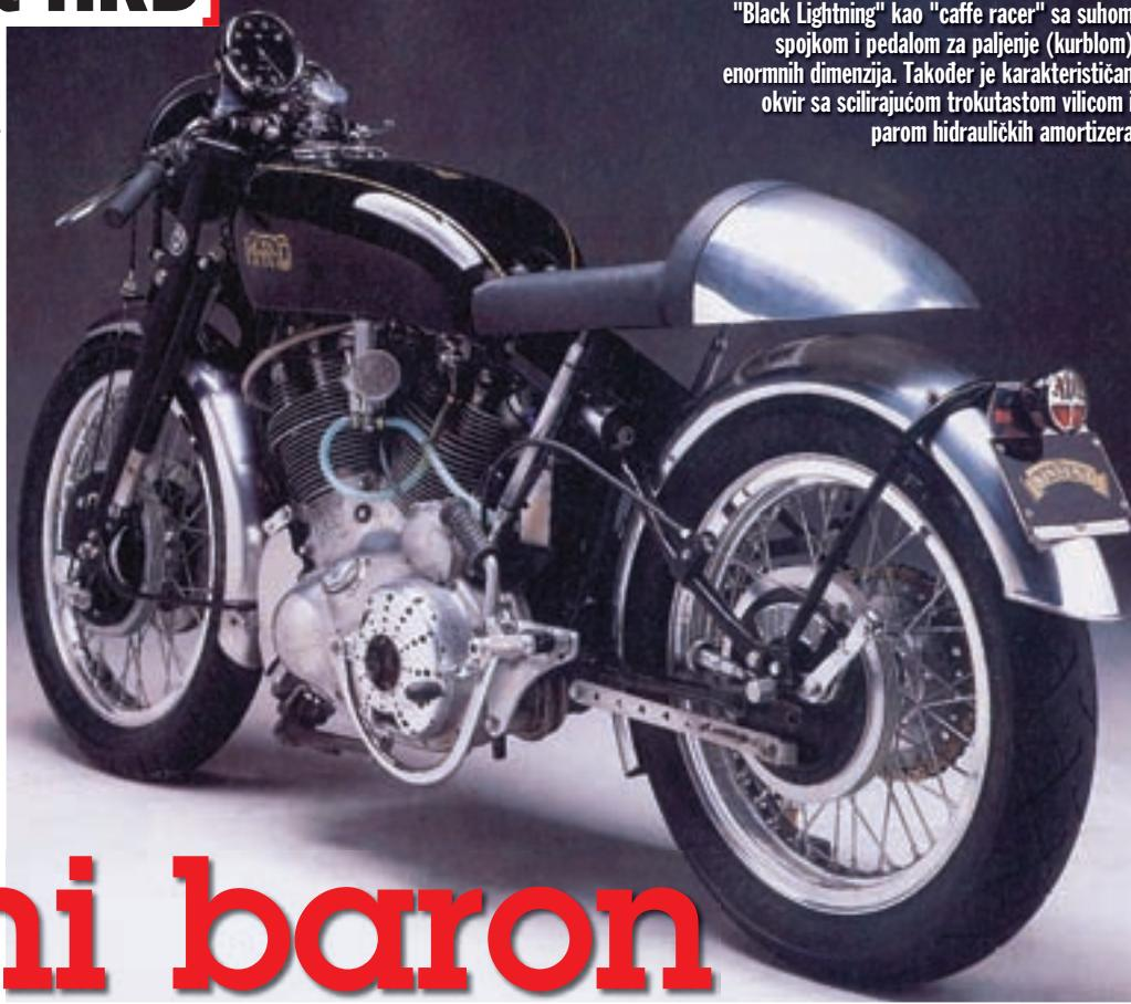
"Black Lightning" kao "caffè racer" sa suhom spojkom i pedalom za paljenje (kurblok) enormnih dimenzija. Također je karakterističan okvir sa scilirajućom trokutastom vilicom i parom hidrauličkih amortizera
