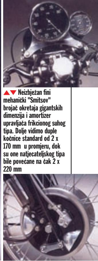
▲ Neizbjegjan fini mehanički "Smitsov" brojač okretaja gigantskih dimenzija i amortizer upravljača friкционog suhog tipa. Dolje vidimo duple kočnice standard od 2 x 170 mm u promjeru, dok su one natjecateljskog tipa bile povećane na čak 2 x 220 mm
