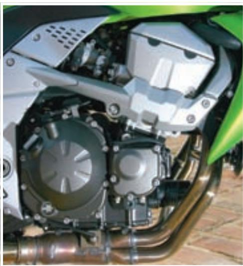
◀ Prihvatile točke motora sada su smještene iza cilindara, što je rezultiralo znatnim smanjenjem vibracija
