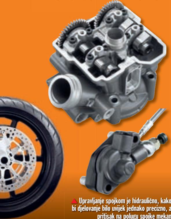
▲ Upravljanje spojkom je hidraulično, kako bi djelovanje bilo uvek jedнако precizno, a pritisak na polugu spojke mekan
