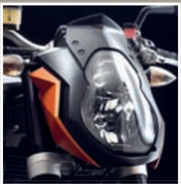
▲ Redizajnirana vjetrobranska maska je nešto kompaktnejih dimenzija, ali zato osigurava bolju vjetrobransku zaštitu zahvaljujući malom usmjerivaču zraka smještenom ispred instrumenata
