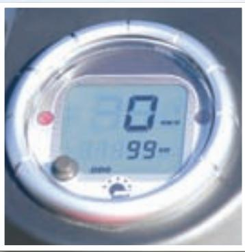
LCD sadrži podatke o brzini, prijeđenim kilometrima te izabranom stupnju prijenosa i trenutno odabranoj vrsti pogona. Kontrolne žaruljice su samo dvije, za pritisak ulja i temperaturu rashladne tekućine
