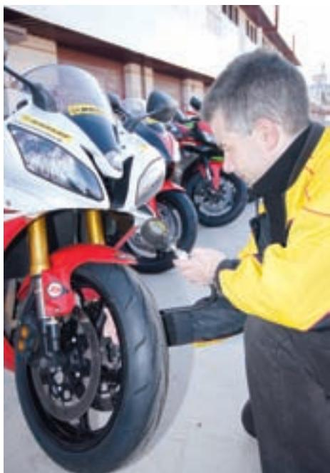
omogućuje bolje prianjanje i veću stabilnost, a ujedno i jednakomjerne trošenje. Ovako čvrsta konstrukcija teoretski bi trebala smanjiti nagomilavanje toplinske energije i deformacije. Poboljšanja u izvedbi JLB pojasa i kompletnoj konstrukciji očituju se i u manjoj težini gume, što povoljno utječe na žiroskopski efekt i na dinamičke karakteristike motocikla.
