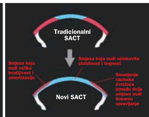
Razlika između tradicionalne SACT i nove SACT tehnologije nanošenja slojeva različite tvrdoće površine gume
