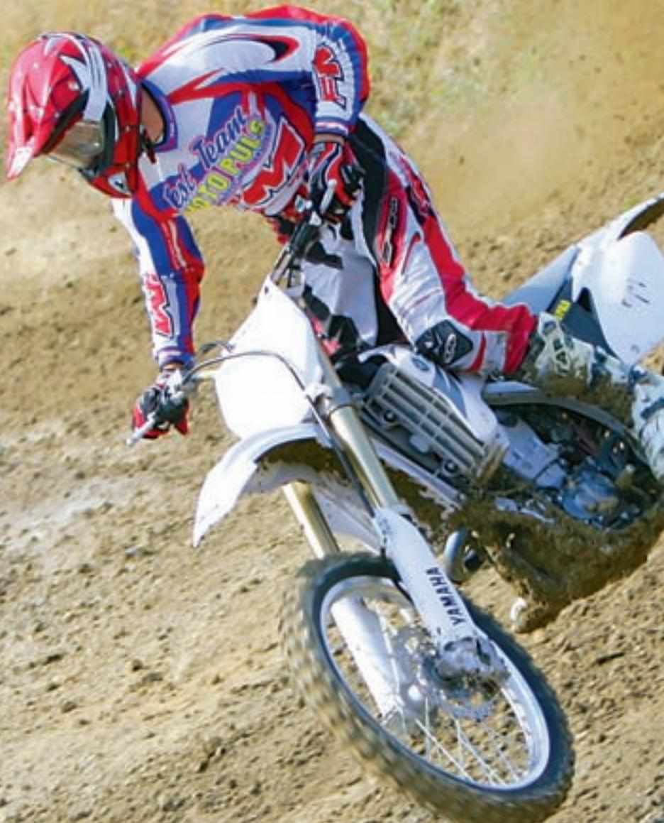
Osim olakšanih cijevi prednje izokrenute vilice izmjenjeni su i trokuti upravljača. Umjesto komponenti od lijevanog aluminija ugrađeni su kovani, koji su krući i lakši
