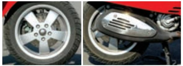
Ispušni sustav nepravilnog i zaobljenog oblika posve je u skladu s izgledom Vespe i nezamislivo nam je ovdje ugraditi neki od sportskih "topova". Lijepi petokraki naplatci promjera 12" na sebi nose kišne gume Sava Monsun dok su učvršćeni malo neuobičajeno, imbus vijcima.
