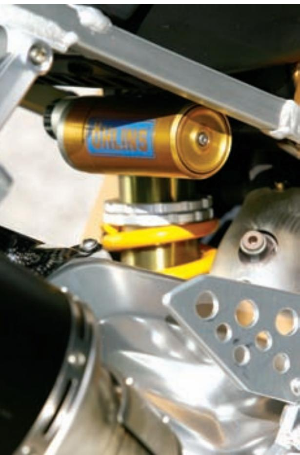
Visoko sofisticirani Ohlinsovi elementi ovjesa (gore) podesivi po svim parametrima. Prednja upside-down vilica promjera 43 mm sa kliznom površinom presvučenom titan-nitridom i jednostruki stražnji amortizer.
