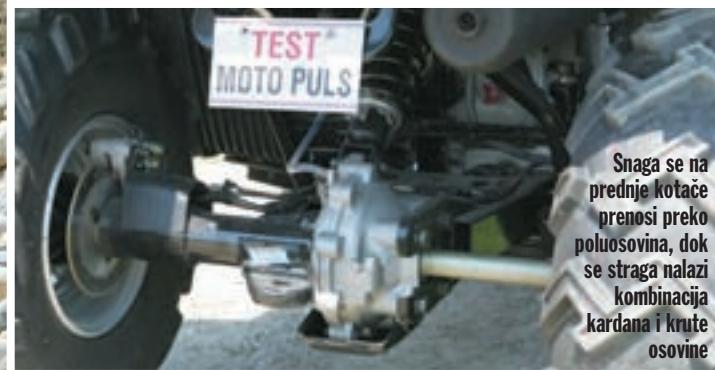
Snaga se na prednje kotače prenosi preko poluosovina, dok se straga nalazi kombinacija kardana i krute osovine
