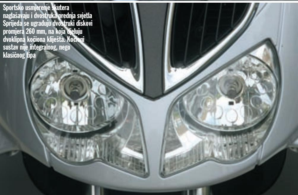
Sportsko usmjerenoj skuteru naglašavaju i dvostruka prednja svjetla. Sprjeđa se ugradjuju dvostruki diskovi promjera 260 mm, na koja tječuju dvoklipna kočiona klješta. Kočioni sustav nije integralnog, nego klasičnog tipa
