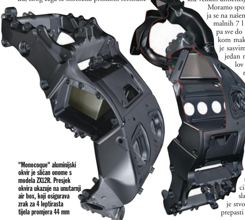
"Monocoque" aluminijski okvir je sličan onome s modela ZX12R. Presjek okvira ukazuje na unutarnji air box, koji osigurava zrak za 4 leptirasta tijela promjera 44 mm
