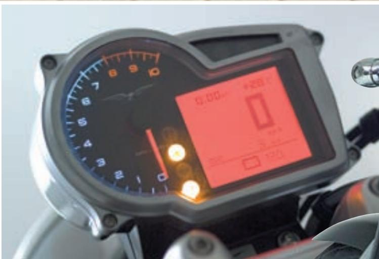
Upravljačka ploča je kompaktna i moderna, a izvedena je u modernom obliku kao kombinacija analognog brojača okretaja i digitalnog zaslona na kojem se može očitati mnoštvo funkcija. U stvari, riječ je o pravom malom računalu!
