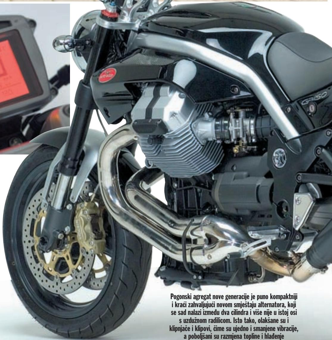
Pogonski agregat nove generacije je puno kompaktniji i kraci zahvaljujući novom smještaju alternatora, koji se sad nalazi između dva cilindra i više nije u istoj osi s uzdužnom radilicom. Isto tako, olakšane su i klipnjače i klipovi, čime su ujedno i smanjene vibracije, a poboljšani su razmjena topline i hlađenje
