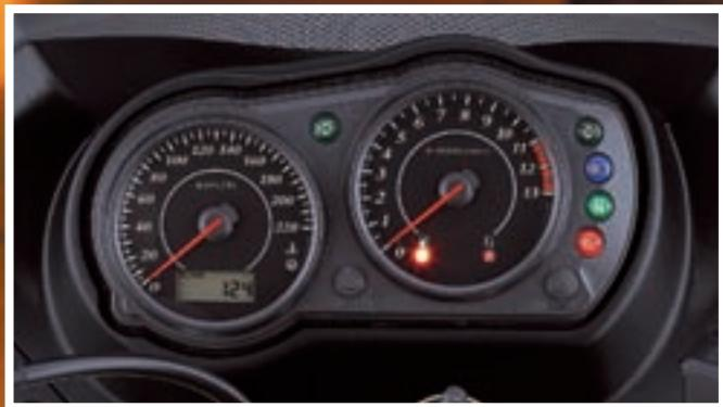
Instrument ploča nema digitalni brzinomjer kao ER6n, već su oba instrumenta analogna. Nisu osobito moderna, ali su zato jako pregledna. Za jedan putni motocikl nedostaje mjerac temperature i količine goriva u spremniku
