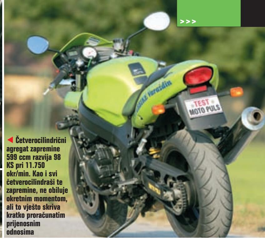
◀ Četverocilindrični agregat zapremine 599 ccm razvija 98 KS pri 11.750 okr/min. Kao i svi četverocilindraši te zapremine, ne obiluje okretnim momentom, ali to vješto skriva kratko proračunatim prijenosnim odnosima
