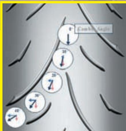
kopskog efekta i dinamičke karakteristike motocikla. Gazni sloj ima čak četiri umetka, dva najlonska i dva armirana pojasa, čime je postignuto bolje prigušivanje i zadržavanje pravilnog oblika gaznog sloja. Osim toga, upravljanje je stupnjevitije i preciznije. Ovakva čvrsta konstrukcija trebala bi teoretski smanjiti deformacije i nagomilavanje toplinske energije.
