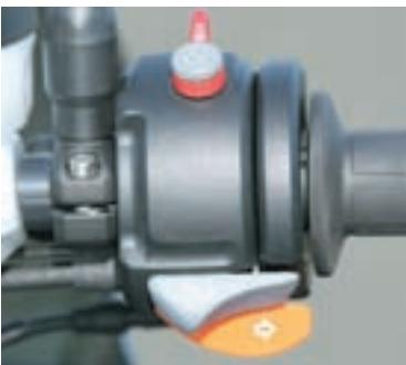
Treba se malo naviknuti da je lijevi pokazivač smjera s lijeve strane, a desni s desne, a tipka za isključenje je odvojena
