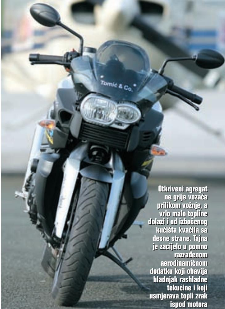
Otkriveni agregat ne grijе vozačа prilikom vožnje, a vrlo malо topline dolazi i od izbočenog kućišta kvačila sa desne strane. Tájna je zaciјelo u ponomo razrađenom aerodinamičnom dodatu koji obavija hladnjak rashladne tekućine i koji usmjerava topli zrak ispod motora
