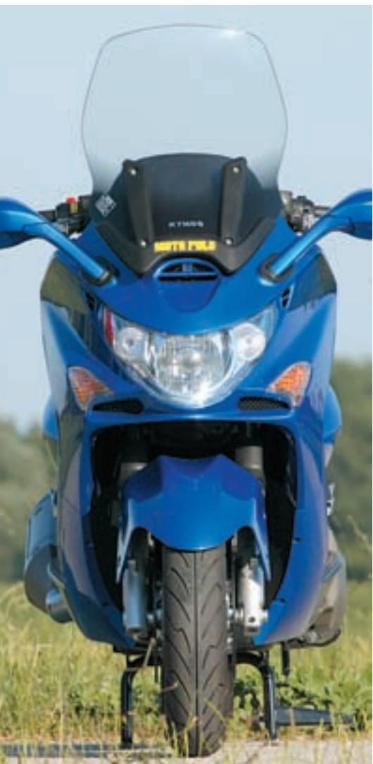
120/70 sprjeda te 150/70 straga. Kočenje je integralnog tipa, s tri diska, od kojih su prednja dva promjera 260 mm, dok se straga nalazi jedan disk od 240 mm. Na diskove djeluju kočione čeljusti sa po dva klipiće na koje se, već serijski, ugrađuju kočiona crijeva s metalnom pletenicom. Stražnji amortizeri su obilnih dimenzija i mogu se podešavati u 5 položaja djelovanjem na opterećenje opruge.
