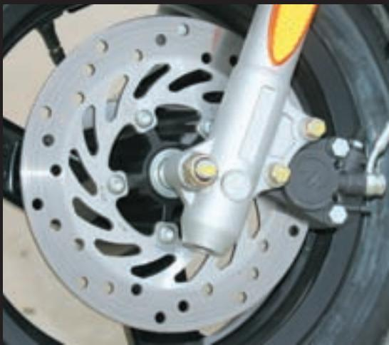
**Kočnice sa diskovima promjera 226 mm sprjeda i 190 mm straga su snažne ali i modulabilne. Uz priloženi racing ispušni sustav snaga motora primjerena je klasi, a ubrzanja su solidna. Rad je vrlo tih i ugađen dok je odgovor na ručicu gasa trenutačan**
