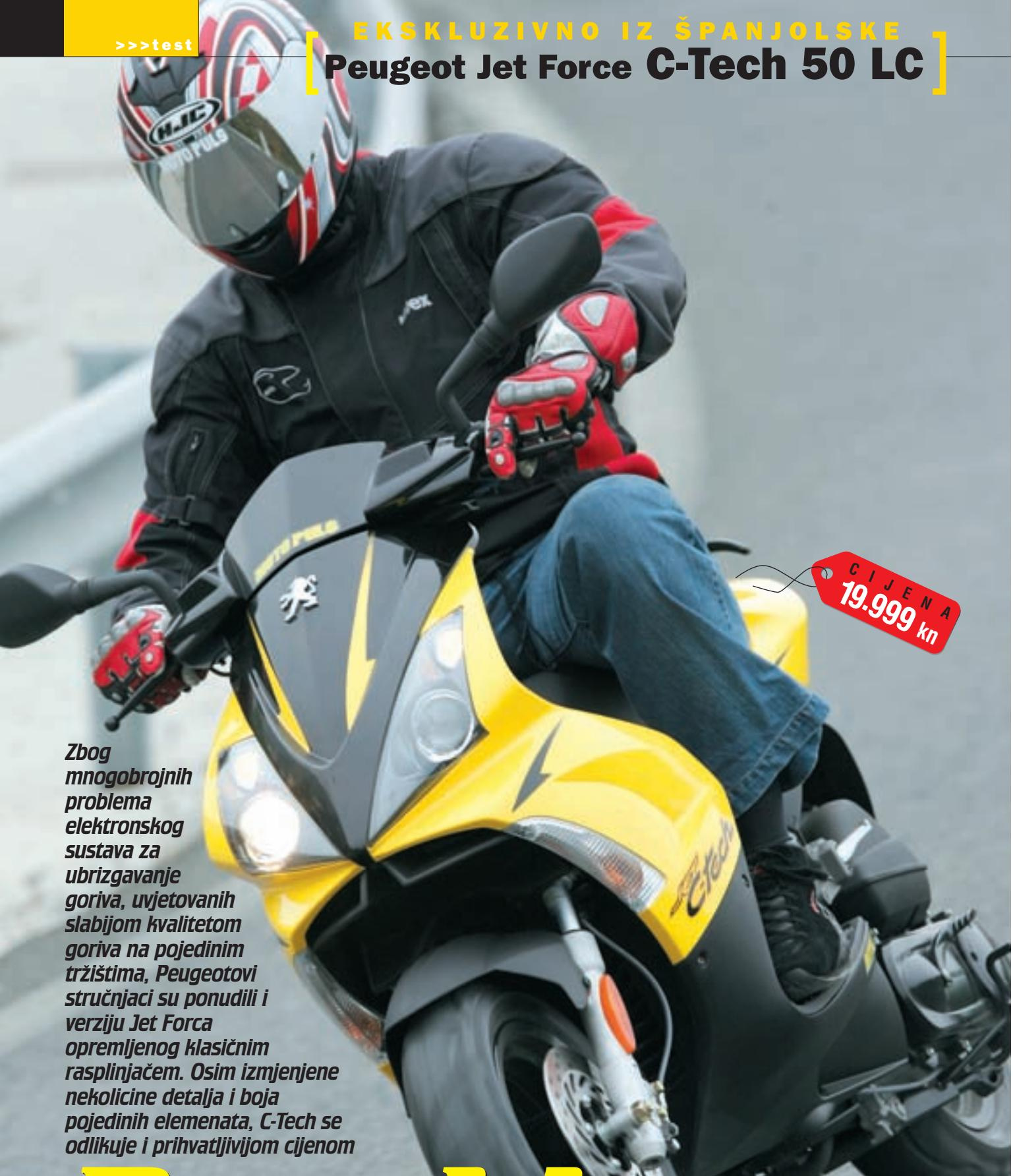
Zbog mnogobrojnih problema elektronskog sustava za ubrizgavanje goriva, uvjetovanih slabijom kvalitetom goriva na pojedinim tržištima, Peugeotovi stručnjaci su ponudili i verziju Jet Forca opremljenog klasičnim rasplinjačem. Osim izmjenjene nekolicine detalja i boja pojedinih elemenata, C-Tech se odlikuje i prihvatljivijom cijenom
