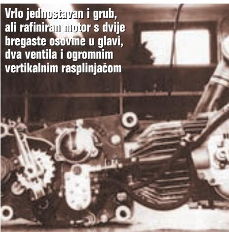
Vrlo jednostavan i grub, ali rafiniran motor s dvije bregaste osovine u glavi, dva ventila i ogromnim vertikalnim rasplinjačom
