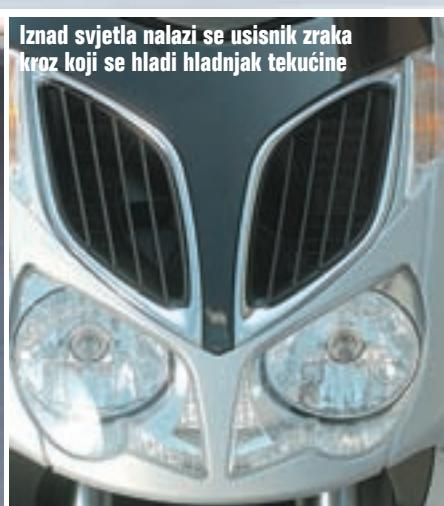
Iznad svjetla nalazi se usisnik zraka kroz koji se hlađi hladnjak tekućine
