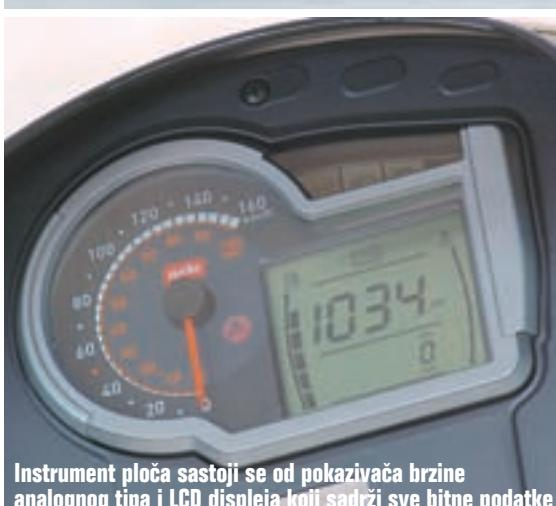
Instrument ploča sastoji se od pokazivača brzine analognog tipa i LCD displeja koji sadrži sve bitne podatke
