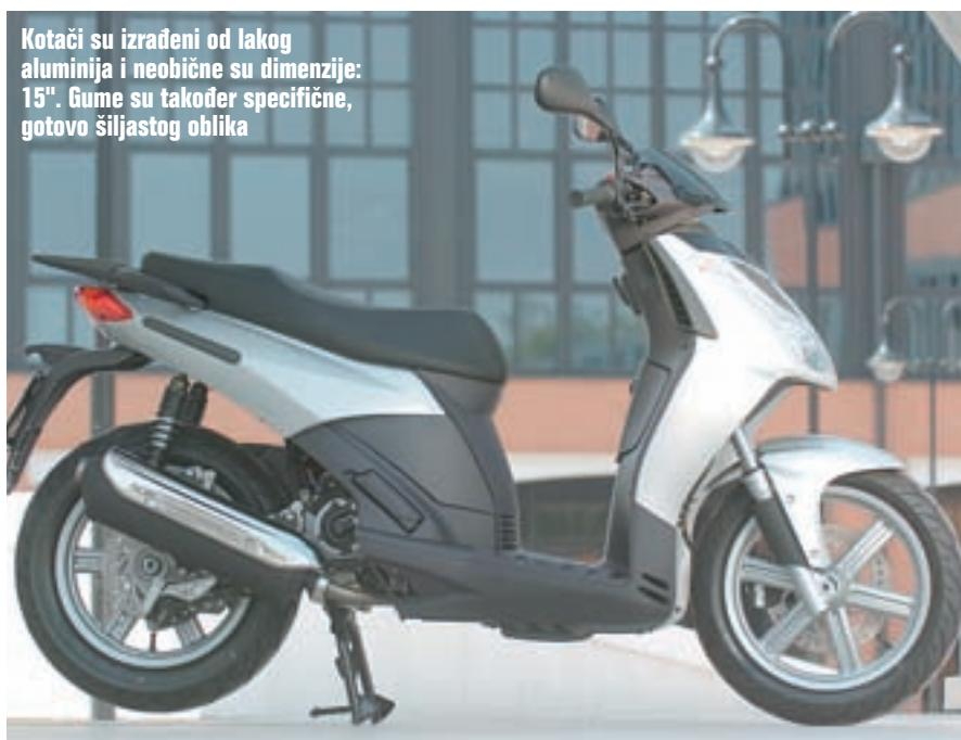
uje disk promjera 260 mm na kojeg djeluje plivajuća čeljust sa dva klipića, dok je straga disk promjera 240 mm. Gledajući kočnice pojedinačno, s obzirom na veličinu diskova, zaustavljanje je moglo biti i snažnije. Možda je ipak trebalo ugraditi integralni sustav, no s vremenom ćete se naviknuti na radnju pritiskanja obje ručice istodobno, što će rezultirati boljom zaustavnom snagom.
