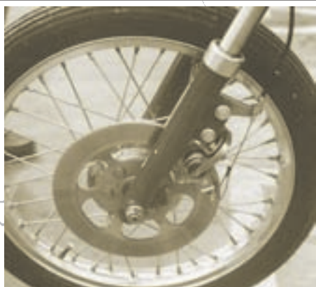
Modifikacija prednje kočnice s bubnja na disk. Klijesta su mehanička, a komanda putem sajle. U ono doba vrlo rijetko tehničko rješenje
