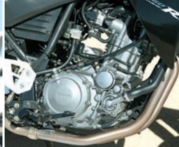
**Motor krasí direktno ubrizgavanie goriva, vrlo mala glava i 4 umjesto 5 ventila po cilindru. Kočnice Brembo različitih diametara klipišta su mnogo snažnije zbog većih performansi**
