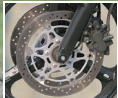
Sprjeda se ugrađuju dvostruki plivajući diskovi promjera 310 mm na koje djeluju dvoklipna kočiona kliješta, a straga disk promjera 260 mm i jednoklipna kliješta
