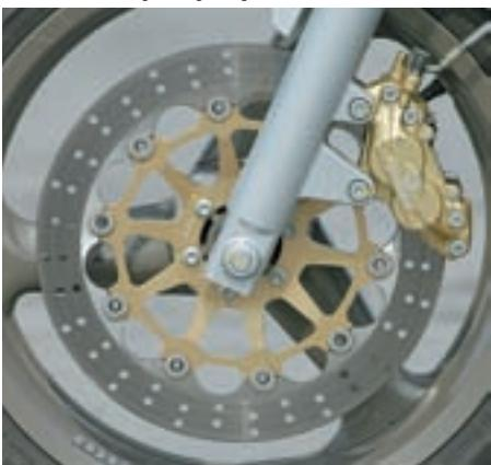
Sustav kočenja sastoji se od prednjeg diska promjera 320 mm na koji djeluje čeljust Brembo Serie Oro s 4 klipića. Straga se nalazi disk promjera 260 mm na koji djeluje čeljust s dva klipića
