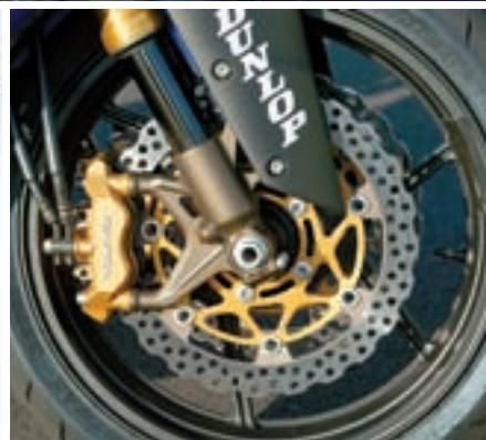
Nazubljene diskove prve je ugrađio Kawasaki a pomažu efikasnijem odvođenju topline. dimenzija je klasična 220 mm
