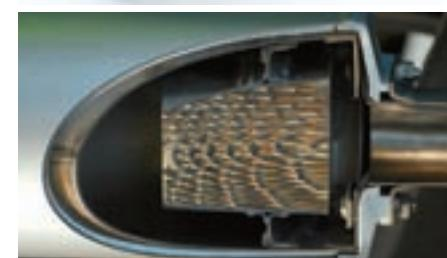
Presjek trostaznog katalizatora zaduženog za čistu ispuh. Nije ugrađen za sva tržišta
