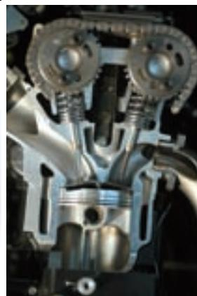
Svi dijelovi glave motora su minimalizirani do detalja. Obratite pažnju na tijelo klipa i deblijinu ventila
