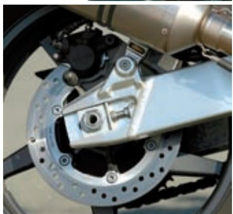
Prednji kočioni sustav preuzet s CBR-a 900 iz '98 g., dvostruki diskovi promjera 310 mm i čeljusti s 4 klipića dok se straga nalazi disk promjera 256 mm i jednoklipna klješta. Stražnja vilica od ekstrudiranog aluminija masivnih je dimenzija, a kotači od lake slitine su sa 5 krakova
